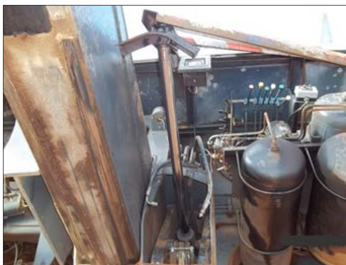
Figura 26 – Rompimento da haste do estabilizador dianteiro direito.
