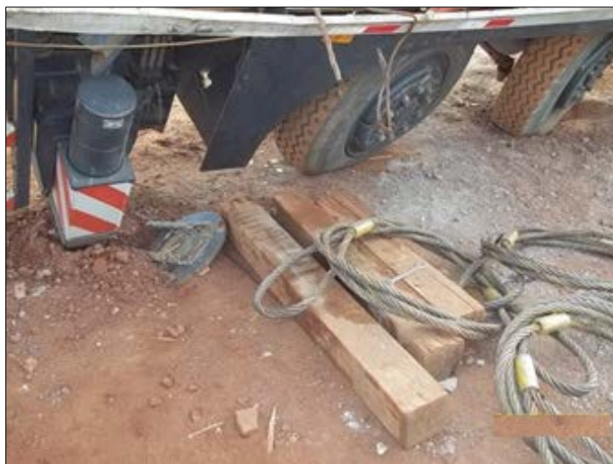
Figura 28 – Integridade do solo no estabilizador dianteiro.
