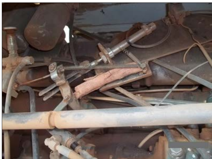
Figura 29 – Calço de madeira no acelerador do guindaste.
