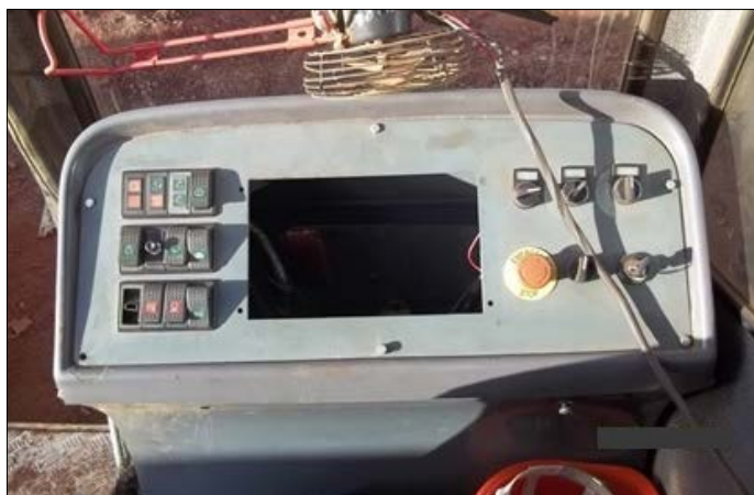
Figura 30 – Inexistência do display LMI.
