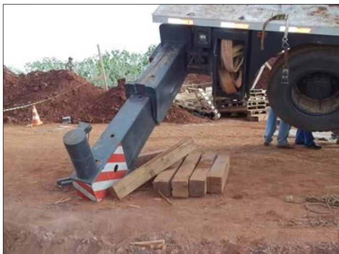
Figura 27 – Integridade do solo no estabilizador traseiro.
