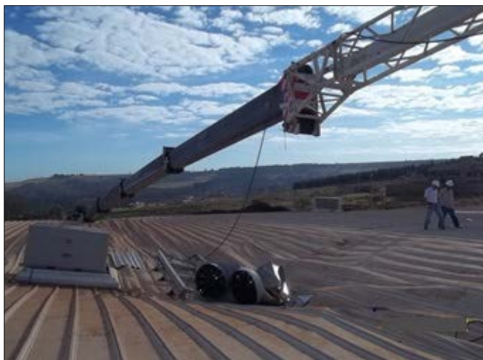
Figura 23 – Lança telescópica totalmente estendida.
