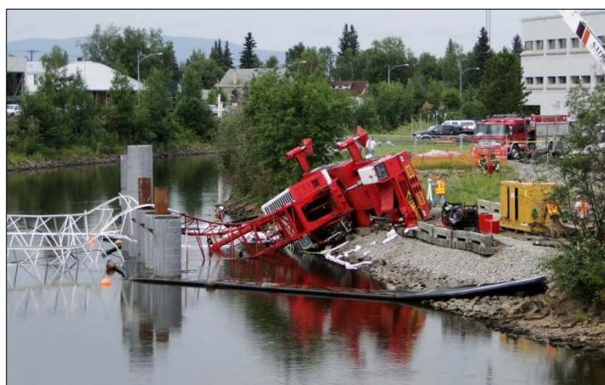
Figura 2 – Tombamento de Guindaste Móvel.
